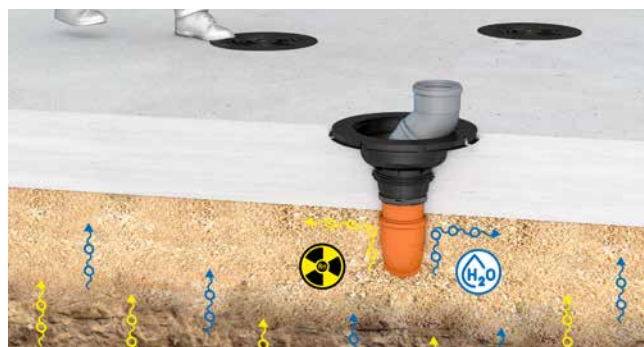
AT110 intégré dans la dalle, étanche à l'eau et aux gaz, avec possibilité de compensation des tolérances et de raccordement à une barrière anti-vapeur
