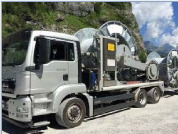
Verlegefahrzeug MAN TGS 28-320 (6 x 6)
