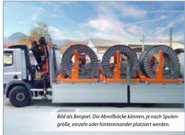
Spulenböcke für den Einsatz auf LKW und Anhänger (2 x 6)
