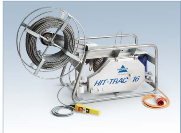
Habegger HIT Trac 16 E, elektrisch mit Seil ca. 200 m, 60 m Zugkraft 1,5 t
