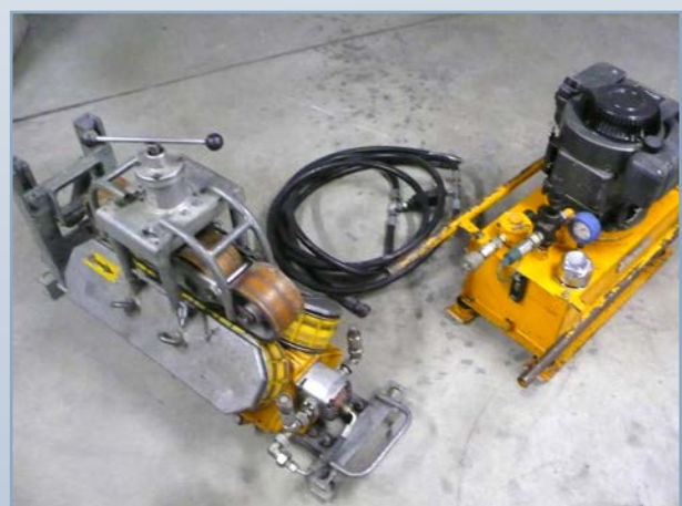
Kabelstosssraupe (eine Raupe mit Benzinantrieb, eine weitere mit Elektromotor)
