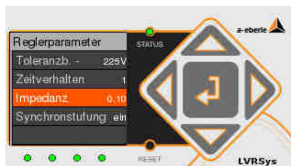
Paramétrage impédance du réseau
