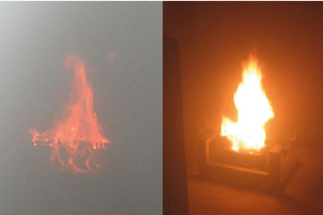
Rauchentwicklung im Test EN 61034. Links ein stark rauchendes Kabel, rechts ein Kabel, welches die Anforderungen erfüllt.
