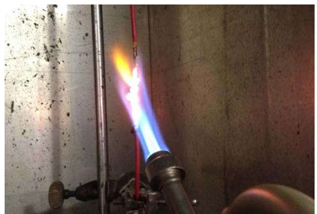
*Essai de résistance à la propagation de l'incendie sur un câble isolé conformément à l'EN 60332-1, l'exigence de base.*
