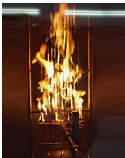
*Les principaux paramètres exigés pour les câbles dans le règlement sur les produits de construction sont déterminés à l'aide de l'essai conformément à l'EN 50399.*
